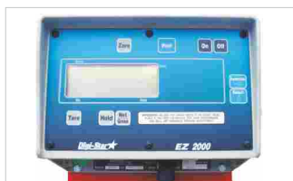
De Vertifeed is ook leverbaar met een elektronische weeginrichting, waarbij via een gemakkelijk te bedienen display het gewicht nauwkeurig wordt weergegeven.
