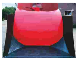
Solide geconstrueerde laadklep met brede slijtstrip en hoge zijwanden. De rondingen in de hoeken centreren het blok bij het opscheppen.
