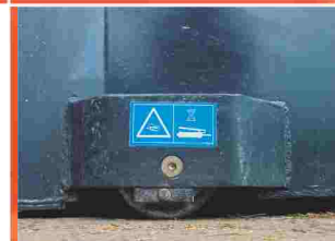
De speciale loopwielen onder de laadklep vergemakkelijken het opscheppen van het kuilvoer en voorkomen onnodige slijtage aan de klep.
