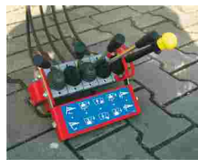
Mechanische afstandsbediening via bowdenkabels.
